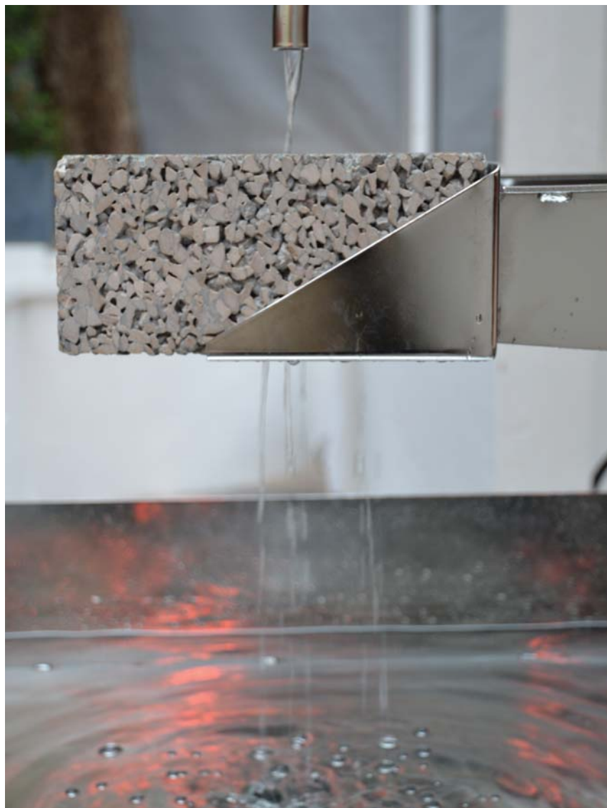
Beton Hydromedia uvedený na trh v roce 2011 slučuje propustnost s vysokou mechanickou odolností. Nabízí praktické řešení problémů spojených s nepropustností půdy v městských oblastech, a tím pomáhá snížit riziko záplav.
