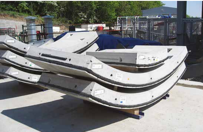
Obr. 9 Po obvodu každého ze segmentů je upevněn těsnicí pryžový pás.
