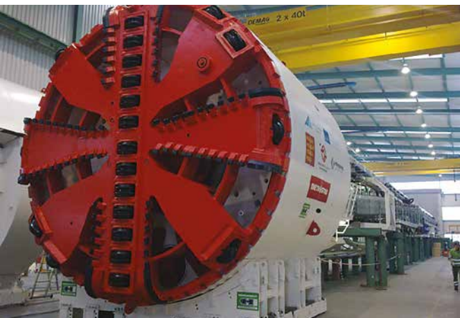
Obr. 11 Jeden ze dvou zeminových štítů pro ražbu metra V.A.
