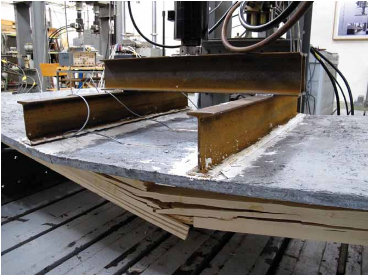
Obr. 7 Způsob porušení výseku dřevobetonové stropní konstrukce
