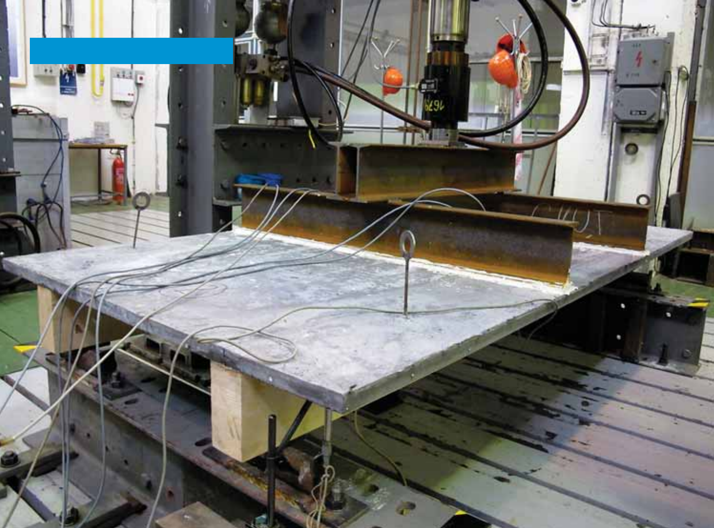
Obr. 6 Experimentální ověření velkoformátového výseku stropní konstrukce
