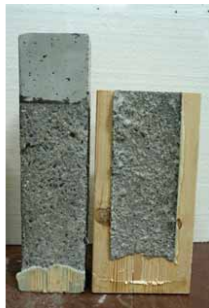
Obr. 4: Způsob porušení dřeva – OPC
