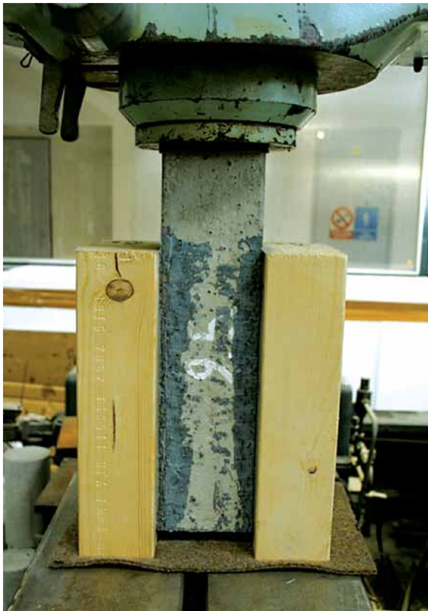
Obr. 5: Způsob porušení dřeva – UHPC 160
