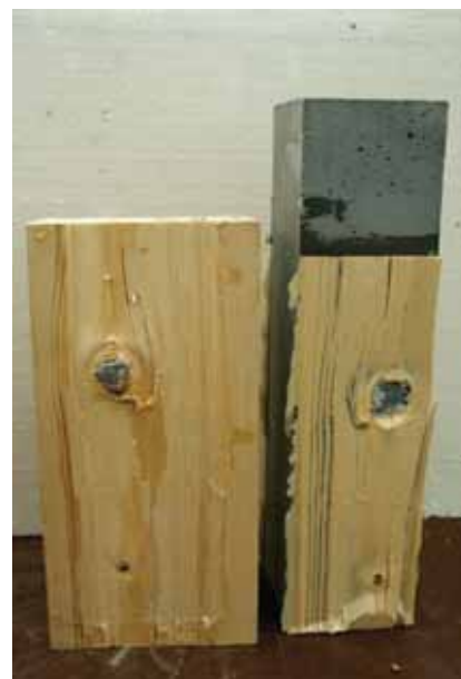
Obr. 5: Způsob porušení dřeva – UHPC 160
